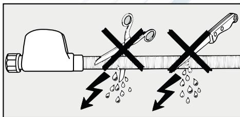
**Не допускается повреждение или порыв защитной оболочки.**
