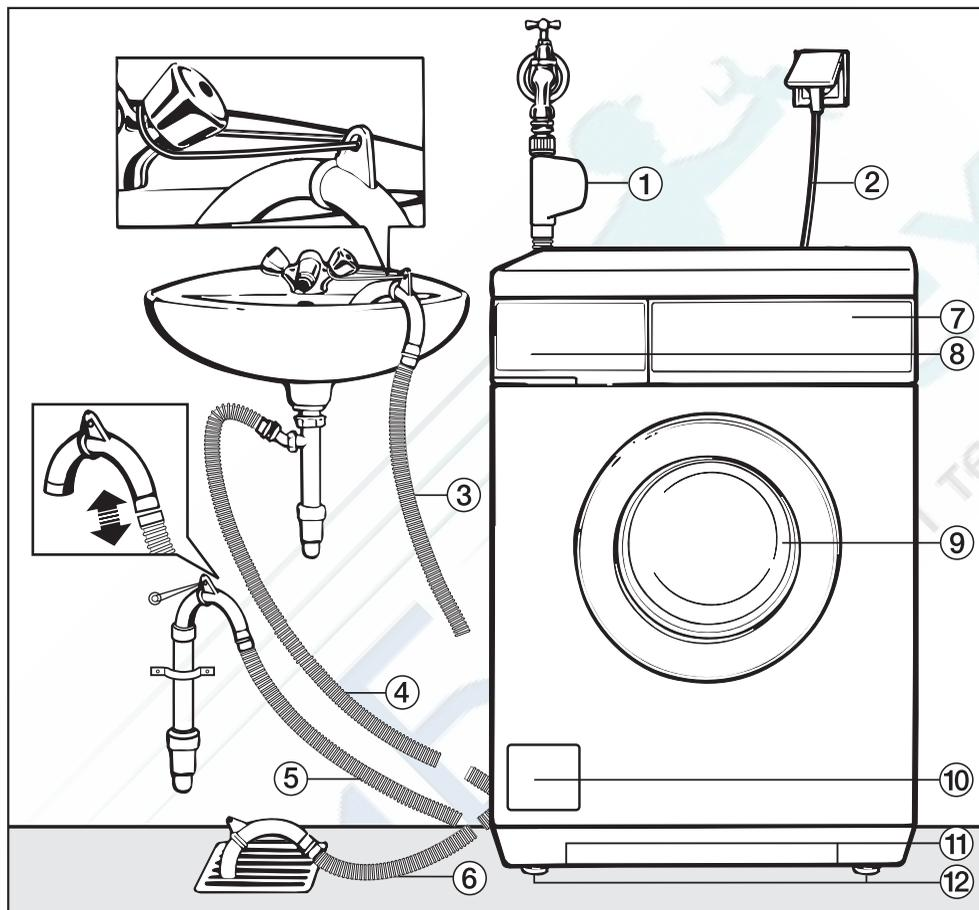
① Система Waterproof (защита от протечек) заливного шланга
